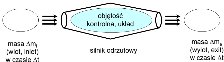
Rys. 7.2. Urządzenie cieplne (w tym przypadku silnik odrzutowy) i czynnik termodynamiczny.
